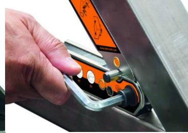
Idéal pour positionner vos pièces avant de souder. 15kg de force magnétique. Clé 6 pans fournie pour blocage réglage angle. Embout fourni pour blocage réglage à 30°-45°-90°/270°-180°. Avec orifice hexagonal pour faciliter le détachement de l'aimant du métal.
