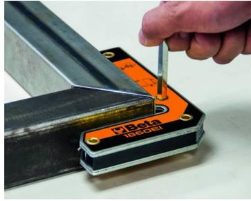
Idéal pour positionner vos pièces avant de souder. 18kg de force magnétique avec ébavurage pour angles de 30° et 60° et orifice hexagonal pour faciliter le détachement de l'aimant du métal.
