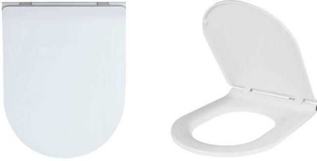
Destiné aux cuvettes de forme D, cet abattant D-ECO se déclipse en un tour de main. Abattant de WC en résine polypropylène à descente assistée, avec couvercle, garantie 3 ans, teinté dans la masse blanc 1,6 Kg. Angle d'ouverture 98°. Fixations par platine excentrique, vis et capot inox, par le dessus, sur 4 tampons antidérapants. À installer sur toute cuvette normalisée de forme D avec entraxe 120 à 220 mm.
