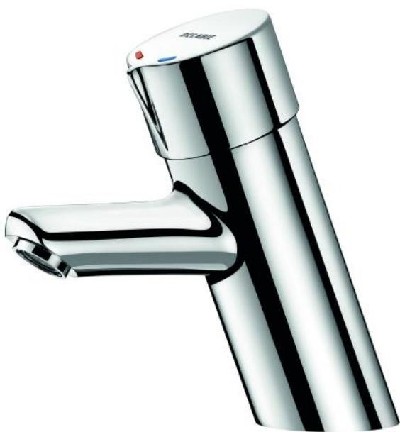
Mitigeur de lavabo temporisé mono-commande à poser sur une vasque. Déclenchement souple. Réglage de la température et déclenchement sur le croisillon. Temporisation ~7 secondes. Débit préréglé à 3 l/min à 3 bar, ajustable de 1,4 à 6 l/min. Brise-jet anti-tartre. Corps en laiton massif chromé. Flexibles PEX F3/8" avec robinets d'arrêt, filtres et clapets antiretour. Fixation renforcée par 2 tiges Inox. Butée de température réglable. Croisillon ergonomique en métal chromé. Garantie 10 ans.
