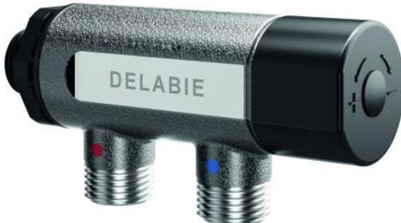
Mitigeur thermostatique pour distribution d'eau mitigée de 30 à 60°C. Alimentation de 2 à 7 postes sanitaires (selon le débit). Sécurité anti-brûlure : fermeture automatique en cas de coupure d'eau froide ou d'eau chaude. Température réglable de 30 à 60°C, verrouillable par l'installateur. Corps en laiton. Filtres et clapets antiretour. Plage de débit recommandé : de 5 à 20 l/min. Choc thermique possible. Garantie 10 ans.
