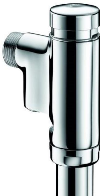
Système de chasse d'eau sans réservoir: par connexion directe à la canalisation. Installation murale en applique. Déclenchement souple. Temporisation ~7 secondes. Protection antisiphonique. Robinet d'arrêt et de réglage de débit/volume intégré. Corps et bouton en laiton massif chromé. Alimentation équerre M3/4". Débit de base : 1 l/sec. Avec tube de chasse en Inox, collier et nez de jonction. Adapté aux PMR. Garantie 10 ans.
