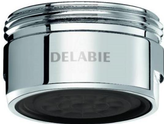
Brise-jet antitarde prétréglé à 3 l/min (brevet DELABIE). Débit réglable de 1,5 à 6 l/min à 3 bar (selon le modèle de robinetterie) par l'extérieur avec une clé Allen 2,5mm. Brise jet sans grille, limite le développement bactérien : pas de rétention d'eau ni dépôt d'impuretés. Garantie 10 ans. Les économies d'eau permises par le brise-jet ECO sont supérieures aux exigences de la classe "Z" de la norme NF EN 246.
