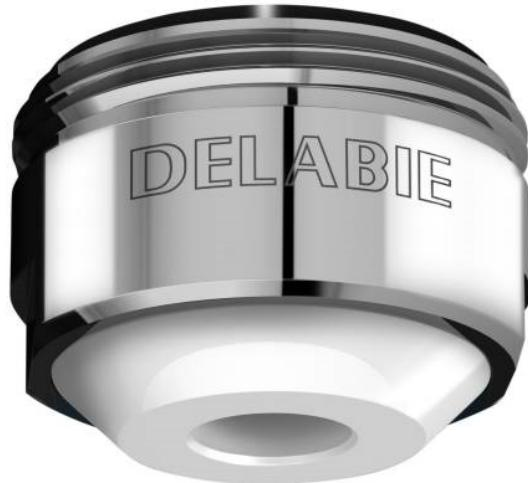
Sortie libre BIOSAFE hygiénique M24/100 pour robinetterie de lavabo en laiton. Surface lisse réduisant le développement bactérien. Sans grille ni cloison en contact avec l'eau. Aucune stagnation d'eau possible dans les parties internes limitant ainsi le développement bactérien. Pièce en Hostaform® réduisant la formation de tartre. Livré individuellement. Ne peut s'installer que sur une robinetterie déjà limitée en débit pour préserver une bonne forme de jet sans éclaboussures.
