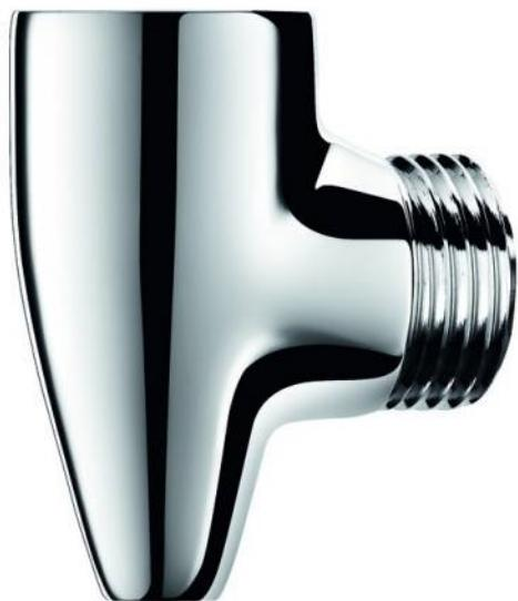
Raccord antistagnation en laiton massif chromé pour vidange automatique du flexible de douche et de la douchette. Empêche toute stagnation d'eau et limite la prolifération des bactéries. Arrivée F1/2" avec joint filtre à raccorder sur la sortie basse de la robinetterie. Sortie M1/2" à raccorder au flexible. À associer avec un flexible court type 834T3 ou 836T3.
