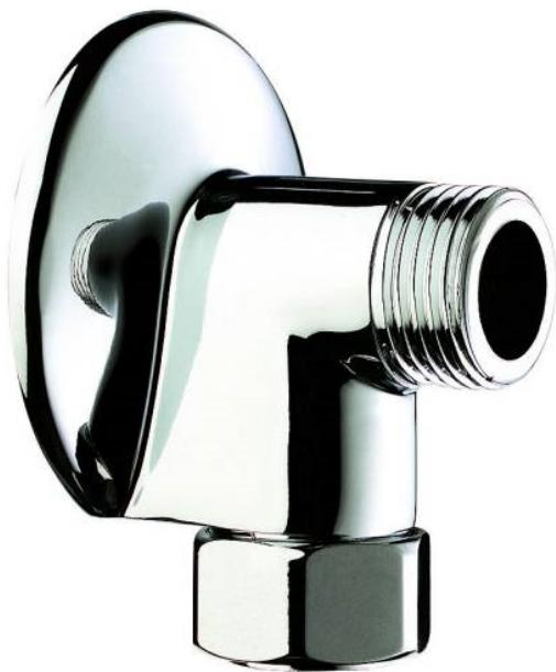
Raccord applique en laiton. Ecrou collet battu Ø 14. Fixation par patte à vis. Garantie 10 ans.
