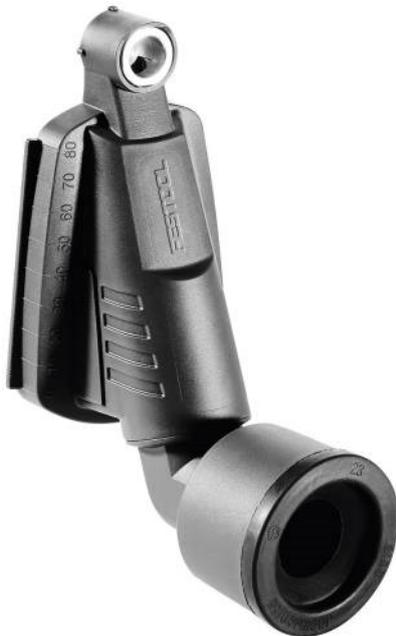
Perçage sans poussière, sans résidu sur le sol, le mur et le plafond jusqu'à max. Ø 12 mm. Système breveté 2 chambres pour un perçage sans résidu et un maintien en toute sécurité. Support en caoutchouc cellulaire pour un maintien sûr même sur des surfaces irrégulières. Articulation flexible permet une position optimale du tuyau.
