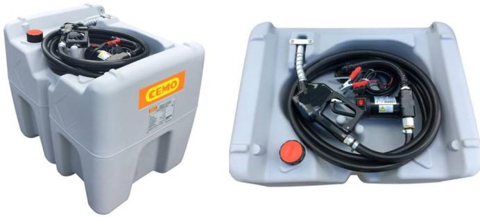
Cuve en polyéthylène simple paroi. Dispositif de rangement du flexible de distribution. Passages de sangles pour arrimer la cuve. Passage de fourches intégré. Support pistolet, bouchon de remplissage, soupape de surpression et d'aération. Poignées de manutention à vide, plots pour l'empilage à vide. Pompe à palettes auto-amorçante Cematic 12/40 12V. Pistolet automatique avec raccord tournant. Ravitaillement de la cuve par pistolet automatique. Pour gasoil, GNR, diesel, fioul.
