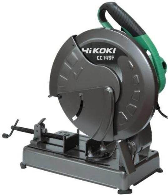
Pour métalliers, découpe acier aluminium jusqu'au Ø 65 mm en plein et Ø 120 mm en creux. Etau à serrage rapide. Coupe à 45°. Double isolation. Blocage de l'arbre. Interrupteur de sécurité.
