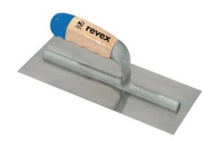
Le platoir italien est un outil composé d'une grande lame en acier de forme rectangulaire reliée à un manche en bois vernis ergonomique. Il est particulièrement adapté au lissage des enduits de finition ou pour enduire les murs et les cloisons. Lame inox. 3 larges biseaux. Epaisseur 0,6 mm. Poids 383 g.
