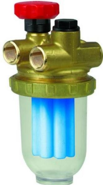
Filtre en laiton pour installation de chauffage fioul bitube. Vanne d'arrêt sur l'aspiration pour éviter l'écoulement du fioul lors de la dépose de la tasse ou lors du démontage du flexible brûleur. Clapet anti-retour. Fixation de sa tasse assurée par une bague de serrage.
