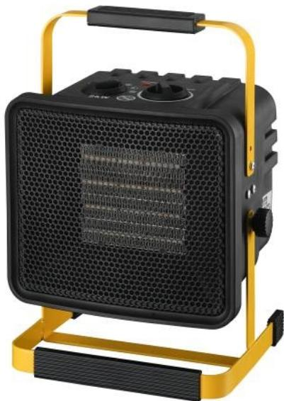
Mise en température très rapide. Surface chauffée : 20 m2. Utilisation aisée : léger, maniable, poignée adaptée. Cordon d'alimentation électrique. Thermostat réglable. Résistance céramique. Ventilateur hélicoïde. Protection thermique contre la surchauffe. Alimentation 230V monophasée. Angle de soufflage réglable : 0 à 30°. Protection IP20.
