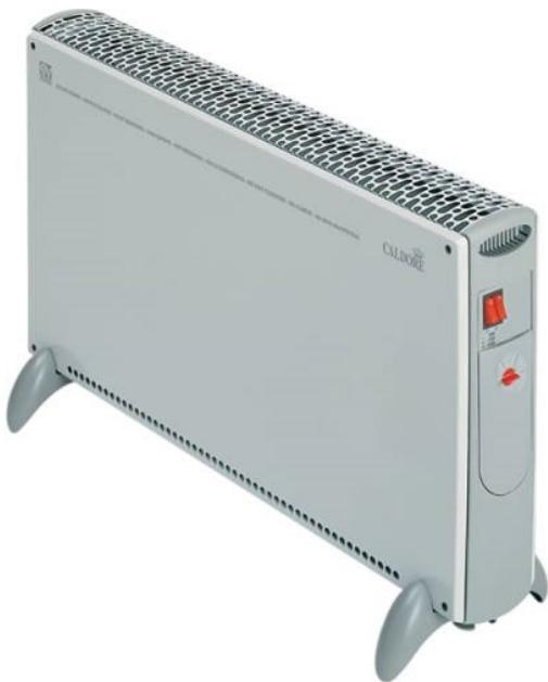
Radiateur mobile sans soufflerie. Il possède un cordon d'alimentation de 1,60m enroulable terminé par une prise Schuko deux broches. Il a une protection IP20 et possède une double isolation électrique (Classe II). Il est homologué CE et construit suivant la norme ISO 9001. Le capot est en acier peint et les panneaux avant et arrière auto extingubiles de couleur gris clair. La résistance électrique est nickel chrome avec protection thermostatique.
