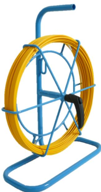
Produit de qualité conçu pour le tirage des câbles souterrains et aériens ainsi que dans les gaines types ICTA et TPC. Cette aiguille continue en fibre de verre enrobée de PVC permet de tirer sans effort les fils sur des parcours tracés. Montée sur dévidoir en acier peint de conception de robuste, ce tire-fils est livré avec 2 embouts filetés en laiton à chaque extrémités montés d'origine.
