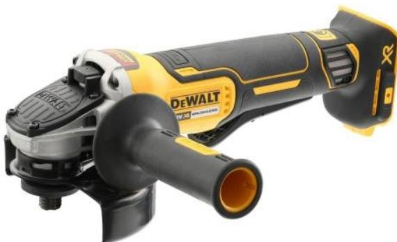
Moteur 18V Brushless. Le frein électronique arrête le disque rapidement lorsque la gâchette est relâchée. L'embrayage électronique réduit la réaction de rebond dans le cas de blocage du disque. Le système d'évacuation Maille limite la poussière aspirée dans le moteur. Le surmoulage en caoutchouc procure une meilleure adhérence et plus de confort pour l'utilisateur. La poignée latérale à deux positions offre un plus grand confort et un plus grand contrôle.
