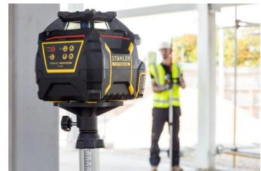
Laser rotatif R600 rouge avec piles, lunettes, cible et cellule. Large poignée pour une meilleure prise. Renfort caoutchouc tout autour du laser.
