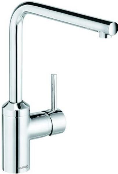
Mitigeur d'évier clipsable DN 15 levier plein. Montage monotrou. Débit classe Z. Mousseur PCA Caché M 16,5 x 1 cartouche céramique avec limiteur eau chaude. Bec d'écoulement orientable (360°) pour montage sous fenêtre. Hauteur du socle : 25 mm. Fixation au socle. Raccords flexibles G 3/8. Classe acoustique I.
