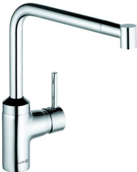
Mitigeur d'évier DN 10. Levier plein. Montage monotrou. Débit classe Z. Mousseur Caché M 24 x 1. Cartouche céramique avec limiteur eau chaude. Bec orientable (220°), extractible télescopiques avec guidage horizontal (245 – 315 mm). Sécurité contre refoulement. Fixation au socle. Raccords flexibles G 3/8. Classe acoustique I.
