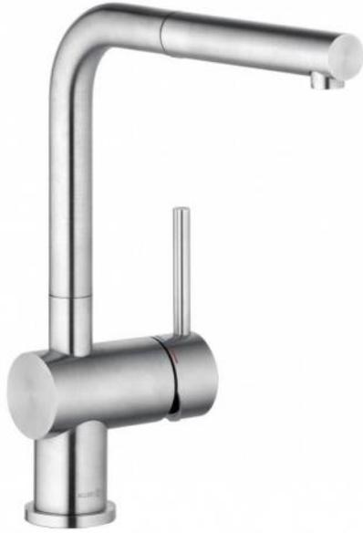
Mitigeur d'évier DN 15. Bec orientable (180°), extractible. Levier plein. Matière: Acier inoxydable. Montage monotrou. Régulateur de jet M 18 x 1. Débit 8,1 l/min à 3 bars. Cartouche céramique avec limiteur eau chaude. Sécurité contre reflux. Raccords flexibles G 3/8 avec fixation au socle.
