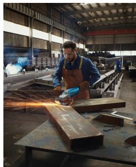
Grande robustesse, performances élevées avec PROtection switch (interrupteur homme mort) pour une meilleure protection de l'utilisateur. Enlèvement de matière élevé grâce au nouveau moteur de 2 200 W garantissant des performances de tronçonnage élevées. Échauffement réduit du moteur et contact amélioré entre le moteur et les charbons pour une longévité plus élevée de l'outil.
