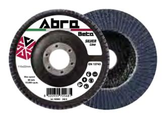
Utilisation pour des opérations sur aciers inoxydables, métaux ferreux et non ferreux. Les grains plus gros conviennentaux travaux de meulage et de dégrossissage, les grains plus fins sont en revanche particulièrement adaptés aux travaux de finition.
