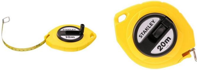
Ruban en acier protégé par un revêtement polymère anti-abrasion. Boîtier fermé ABS antichoc, compact et ergonomique. Boîtier de couleur jaune pour une bonne visibilité. Graduation en mm. Bras articulé : rembobinage rapide du ruban. Manivelle et palette d'accrochage escamotables. Logement de protection pour la palette intégrée dans le boîtier.
