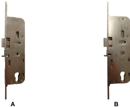
Crémone spéciale rénovation Trimatic. Pêne 1/2 tour et pêne dormant réversible. Ouverture par action de la poignée. Condamnation automatique avec les galets puis avec la clé du cylindre. Relevage de la béquille pour aider au verrouillage. En acier traité FerGUardargent.
