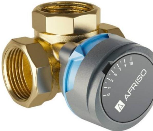
Cette vanne mélangeuse est manuelle. Elle peut être commandée par une régulation via un servomoteur. Échelle très lisible (de 0 à 10 et de 10 à 0). Indicateur de position du secteur. Bouton antidérapant. Très peu de couple nécessaire pour l'ouverture de la vanne, les servomoteurs seront peu sollicités, ce qui augmente leur durée de vie. La vanne peut être utilisée en vanne de dérivation. Taux de fuite réduit. Raccords octogonaux pour serrage avec un outil.
