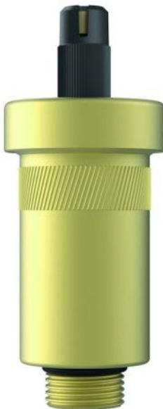
Assure l'élimination de l'air présent dans les installations de chauffage à eau chaude. Permet de diminuer les risques de corrosion et de formation de boue et de supprimer les bruits désagréables. Muni du dispositif AQUASTOP pour empêcher les fuites éventuelles.
