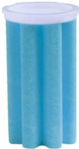
Tamis filtrant pour filtre fioul.Tamis composé d'une multitude de microbilles pour une filtration fine (50 microns). Solution contre le phénomène «bulle d'air» constaté sur les filtres équipés de tamis inox. Surface de filtration étendue grâce à sa forme en étoile.
