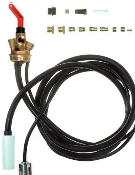
Ensemble d'aspiration pour réservoir fioul. Grâce au flotteur sur l'aspiration, le fioul est aspiré dans la zone propre, au-dessus des boues de fond de cuve. Corps en laiton avec orifice pour le retour. Plongeur d'aspiration. Vanne de police orientable. Clapet anti-retour. Dispositif anti-siphon. Plongeur pour jauge pneumatique. Livré complet avec 2 jeux de raccords et bagues en laiton pour tube de diamètre extérieur 6, 8, 10 mm.
