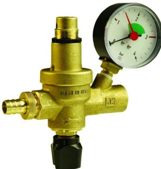
Permet le remplissage des circuits de chauffage à partir du réseau. Pour circuit de chauffage fermé selon NF EN 12828. Il se compose d'un corps en laiton, d'un réducteur de pression, d'une vanne d'arrêt, d'un clapet anti-retour, d'un raccord 1/4" pour manomètre et d'un manomètre.
