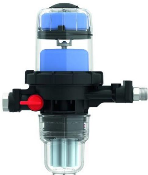
Système de purge et de filtration automatique des conduites fioul monotubes (recyclage) avec robinet d'arrêt. Assure une meilleure sécurité de fonctionnement des brûleurs. Peut-être utilisé pour des citernes en charge. Pour les installations fioul monotubes à recyclage. Convient pour le fioul EL (DIN 51603-1) et le gazole (EN 590) ainsi que le biofioul, max. 30 % de FAME. Egalement adapté pour l'utilisation dans les zones à risque d'inondation.
