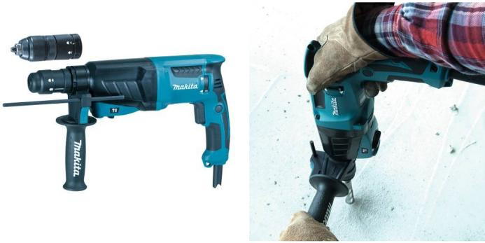
Nouveau système sélecteur plus durable. Mandrins interchangeables à verrouillage rapide (SDS-Plus et autoserrant). 3 fonctions : perçage, perforation et burinage. Variateur de vitesse : La vitesse de l'outil augmente à mesure que l'on accroît la pression exercée sur la gâchette. Limiteur de couple protégeant le moteur ainsi que l'utilisateur en cas de blocage. Équipé d'un guide de profondeur.
