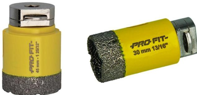
Perçage à sec sans liquide de refroidissement. Positionnement précis grâce à la mèche de centrage. Système Click & Drill. Profondeur de découpe 35mm. S'utilise avec une perceuse sur secteur/batterie. Vitesse de rotation rapide. Matériaux: pierres dures, granit, grès cérame, carrelage.
