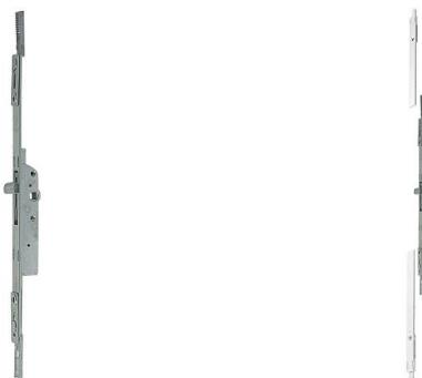
Crémone pour fenêtres et portes-fenêtres à la française. Ajustable en 2 parties par prolongateurs et côte D fixe. Crémone seule : 1 point de condamnation - avec les prolongateurs : 2, 3 ou 4 points. Verrouillage haut et bas et panneton central suivant le modèle. En acier traité FerGUardargent.
