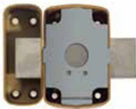
La principale caractéristique du verrou de sécurité B5 d'IFAM est son bouton d'ouverture depuis la partie intérieure de la porte. Corps et gâche en acier embouti, épaisseur 20/10ème. Pêne en acier chromé, d'une longueur de 110 mm et d'une épaisseur de 9 mm. Utilisable sur les portes avec une ouverture à gauche ou à droite.
