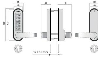
Sans pile, sans câble et sans courant. Conçu pour une utilisation sur des portes ayant une fréquence d'utilisation modérée : chambres, bureaux individuels... Remplace la garniture principale de la porte. Permet de conserver serrure monopoint, cylindre et la clé existants. Code modifiable à volonté. Libre passage en série. Utilisation intérieure et extérieure.
