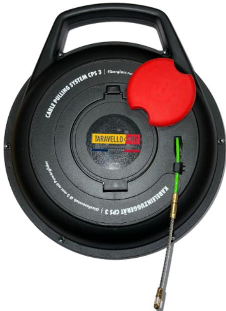
Tire-fils composé d'une aiguille polyester, d'un élément avant fileté M3 (une tête flexible avec œillet de tirage) et d'une poignée de tirage. Le carter dispose d'un compartiment de service pratique pour loger de nombreux accessoires. Ce produit a été conçu pour le tirage et la poussée de câbles dans les parcours tracés de petite et moyenne sections grâce à la flexibilité et la solidité du polyester.
