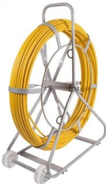
Produit de qualité conçu pour le tirage des câbles souterrains et aériens ainsi que dans les gaines types ICTA et TPC. Cette aiguille en fibre de verre revêtement PVC, de diamètre 9mm ou 11mm, permet d'aiguiller sans effort sur des parcours tracés. Montée sur un dévidoir de conception robuste avec frein central, ce tire-fils est livré avec boule nylon avant Ø30mm et élément final arrière. Dimensions dévidoir: 90x43x111cm.
