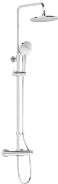
La colonne de douche Aquaheat Joy 220 en acier inox chromé est composée d'une pomme de tête pluie ronde en plastique de diamètre 220 mm et d'un débit 14 l/min et d'un flexible de douche gainé lisse de 1750mm (anti-torsion) avec une douchette avec 3 jets (Aquaspray, Aquamassage et Aquasoft) de diamètre 120mm et d'un débit 12 l/min. Cartouche BluEco &BlueStep / C3. Garantie 5 ans. Dimensions : 802 à 1307x515x270mm
