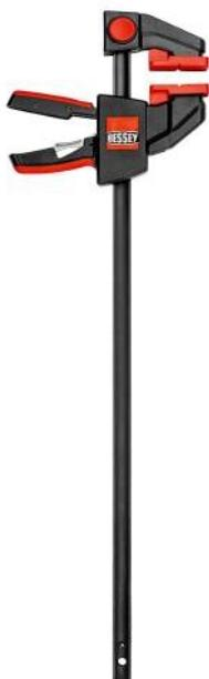
Puissance de serrage de jusqu'à 2700N. Réversible sans outil pour l'écartement grâce à un mécanisme de déverrouillage simple, par pression d'un bouton, sur la partie supérieure. Poignée bi-matière de forme ergonomique avec mécanisme de pompe et levier de déverrouillage intégré à l'arrière du rail. Protections plastiques revêtus de caoutchouc avec prisme cruciforme pour un maintien fiable des pièces rondes, pointues et anguleuses. Commande à une main sans exercer de force.
