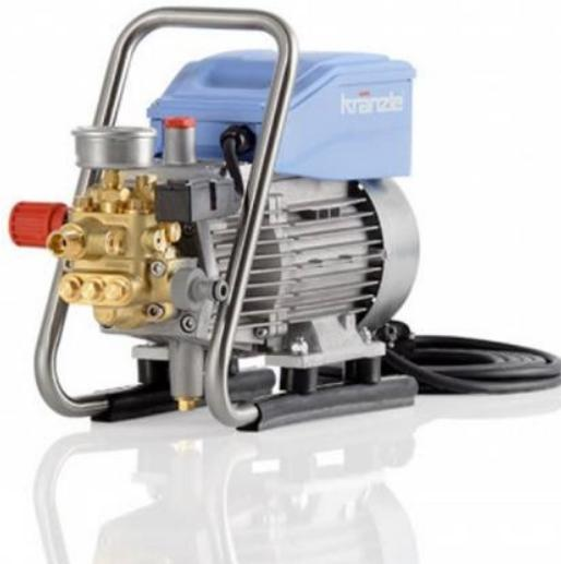
Système d'échange par raccord rapide pour le changement facile et rapide des accessoires. Pompe en laiton forgée. Pistons inox à revêtement céramique. Lances inox et raccords laiton. Système Total Stop temporisé.
