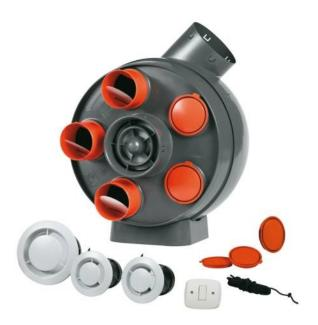
Caisson ABS, couleur noir, fermeturedu caisson par vis. Conception très robuste, plénum de grande dimension et entretien facilité. Très faible consommation électrique 24 W-Th-C. Très faible niveau sonore (Lw < d30 dB(A) en cuisine). Protection thermique intégrée. Fixation suspendue par cordelette fournie, ou sur mur ou au plafond. Prévoir des entrées d'air autoréglables dans les pièces principales. Alimentation 230 VAC. Ventilateur centrifuge à réaction <30W à haut rendementen polypropylène.
