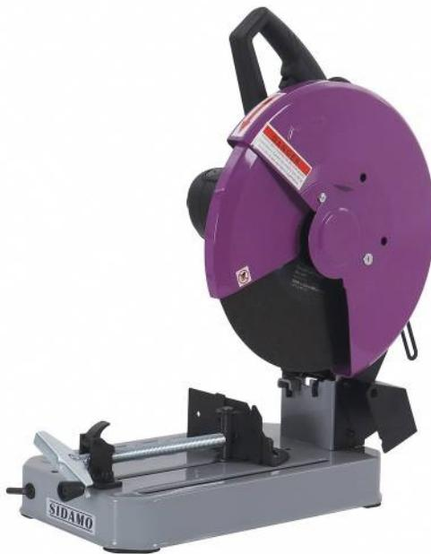
Tronçonneuse à disque abrasif. Tronçonnage d'appoint à sec de métaux ferreux sur chantier. Etau à serrage rapide. Carter de lame mobile à fermeture automatique. Mors d'étau orientables de 0 à 45° à gauche et 15° à droite. Ergot de blocage d'arbre pour démontage aisément du disque. Axe de blocage tête pour le transport. Déflecteur de poussières et d'étincelles.
