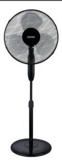
Ventilateur noir design avec hauteur réglable jusqu'à 120cm. Boutons de commande sur le mat, 3 vitesses. Angle d'oscillation 80°, angle d'inclinaison vers le haut 16°, angle d'inclinaison vers le bas 8°. Débit d'air 20m³/min. Alimentation 230V par câble 1,5m. Dimensions 43,5x128x72cm. Poids 4,8Kg.
