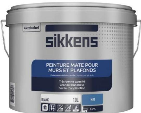
Peinture d'intérieur mate en phase aqueuse pour travaux courants. Usage professionnel. Nettoyage du matériel : eau. Temps de séchage : environ 1 heure. Recouvrable : environ 6 heures. Rendement : ~8-10m<sup>2</sup>/L. Le rendement varie en fonction du type, de l'état, de la surface et de l'absorption du support.
