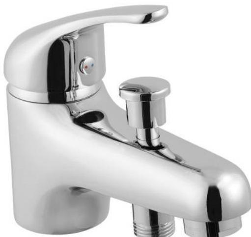
Mitigeur bain douche monotrou. Cartouche céramique type C1, Ø 40 mm. Economie d'énergie grâce à son limiteur de température par cran réglable. Aérateur anti-calcaire Ø 22 mm. Garantie 5 ans.
