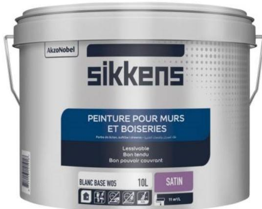
Peinture d'intérieur satinée pour murs et boiseries à base de résines alkydes en phase aqueuse. Lessivable. Bon tendu (selon l'outil utilisé). Bon pouvoir couvrant. Usage professionnel. Nettoyage du matériel : eau. Temps de séchage : environ 6h. Recouvrable : environ 12h.
