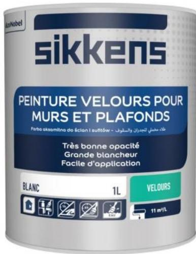
Peinture d'intérieur mate veloutée en phase aqueuse pour travaux courants à usage professionnel. Bonne opacité. Bonne blancheur. Facile d'application. Elle convient pour tous travaux courants de décoration et de finition sur murs et plafonds. Masque avec efficacité les traces de nicotine et les taches d'humidité. Nettoyage du matériel : eau. Temps de séchage : environ 1h. Recouvrable: environ 6h.
